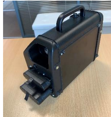
Figure 4: Remote box avec 2 batteries
