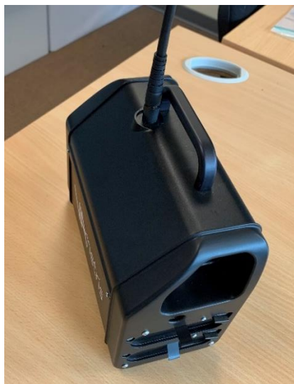
Figure 9: Connexion du câble principal à la remote box
