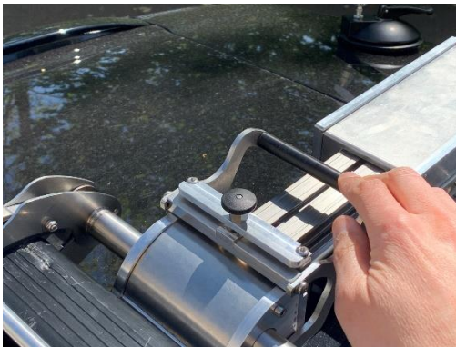
Figure 6: fermer la mâchoire et s'assurer que la goupille soit engagée
