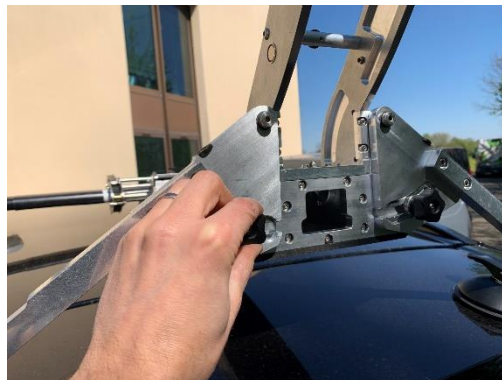
Figure 7: régler l'assiette en ajustant grâce aux mollettes arrière les angles des deux bras latéraux
