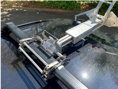
Figure 5: engager la mâchoire avant sur le clamp
