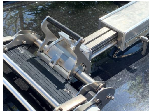
Figure 5: engager la mâchoire avant sur le clamp
