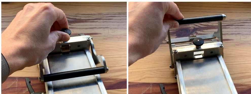
Figure 3: Lever la goupille et ouvrir la mâchoire vers l'avant
