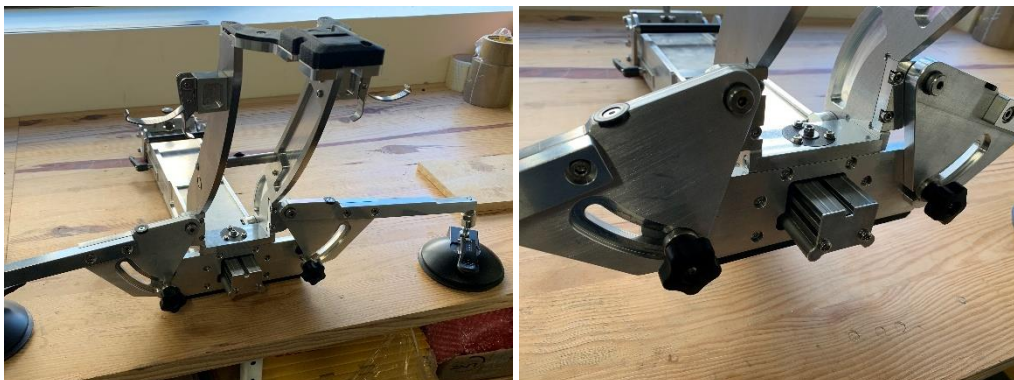
Figure 2: Déplier les deux bras des ventouses et serrer les molettes dans la rainure
