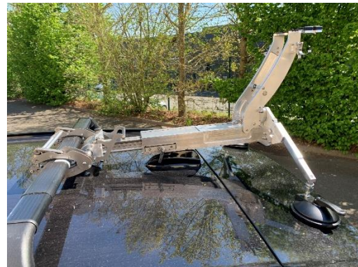
Figure 6: fermer la mâchoire et s'assurer que la goupille soit engagée
