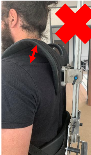
Figure 1: harnais d'épaule positionné trop haut
