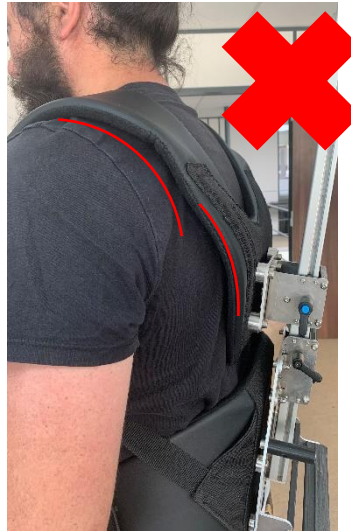
Figure 2: harnais d'épaule positionné trop bas. La courbure du harnais n'épouse pas l'épaule
